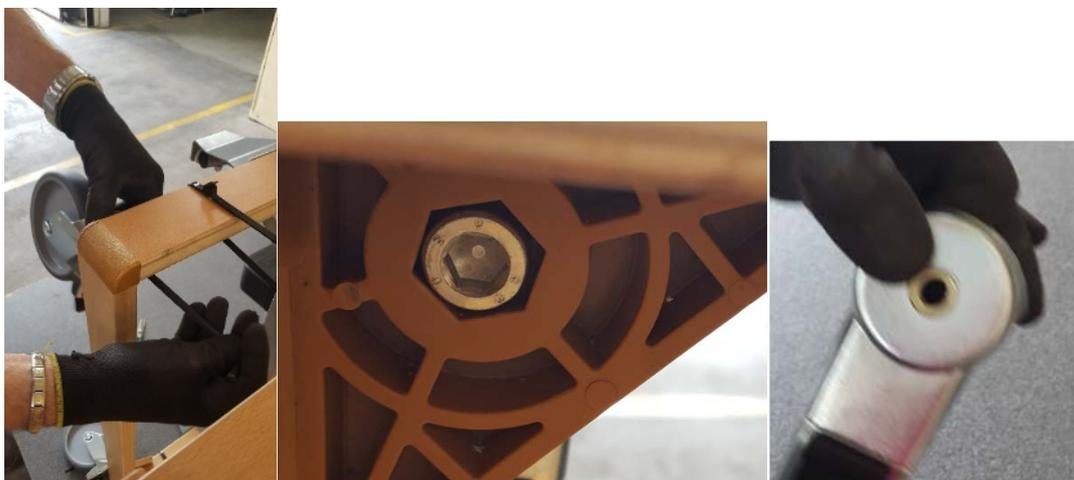
Figura 29 - Sostituzione Ruote
