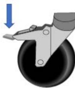
Figura 10 - Inserimento Freno Ruote
