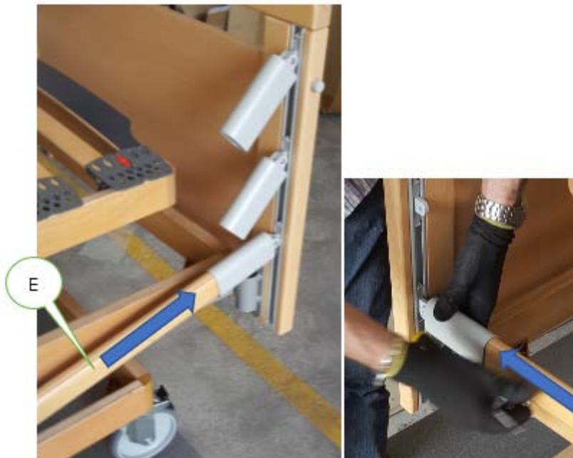
Figura 17 - Installazione Sponde -- Inserimento Asta
